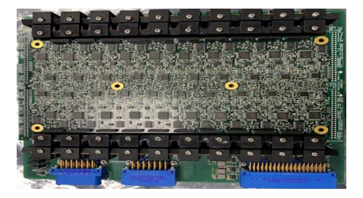
ELECTRONIC CIRCUIT BREAKER WITH REDUNDANT CAN INTERFACE
