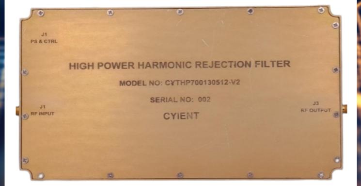
100W HIGH POWER HARMONIC REJECTION FILTER MODULE
